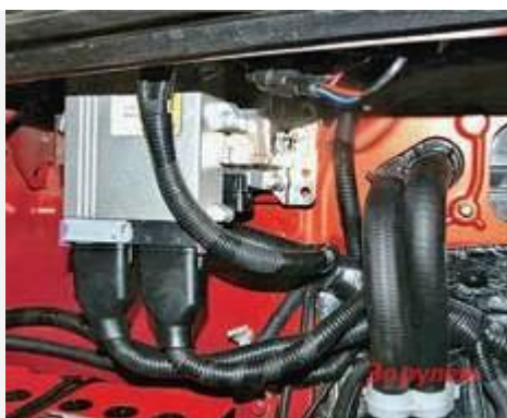
Электронный блок управляет подачей бензина и газа
