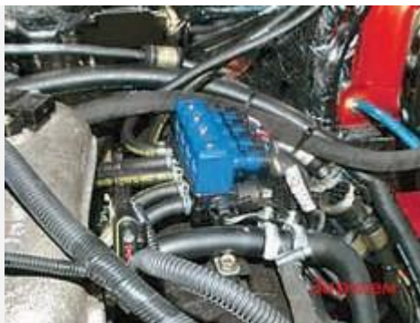
Газ во впускной коллектор впрыскивают форсунки
